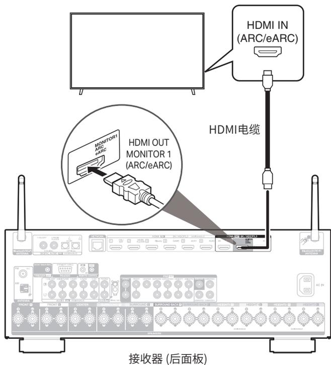
使用高质量的HDMI电缆\*，将一端连接到电视机上标有“eARC”或“ARC”的HDMI端口。将另一端连接到AVR上的HDMI OUT MONITOR 1端口。
